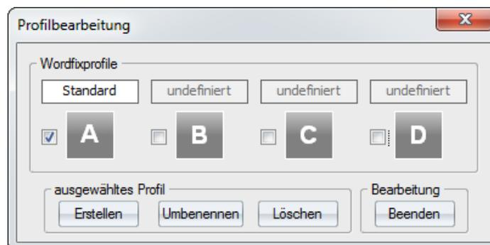
Wird jetzt  betätigt, werden die zuletzt beim Beenden von **Wordfix** bestehenden Einstellungen als Profil (hier Profil A) mit eingegebenem Stichwort (hier *Standard* als Beispiel) abgespeichert. Der Erfolg des Abspeicherns wird durch ein farbiges Symbol angezeigt.
